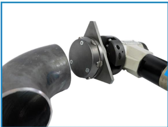
Cette nouvelle génération de kits de préhension pour coudes permet de positionner les machines de la gamme US sur tous les types de coudes. Leur réglage concentrique est rendu possible par des réglettes placées autour du dispositif, ce qui permet de réaliser des préparations à la soudure de parfaite qualité sur tous les types de coudes, y compris les coudes en acier inoxydable ou en aciers alliés.
