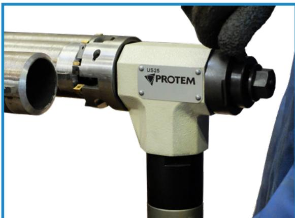
L'option TA remplace le plateau porte-outils par une tête de fraisage sur les machines de la série US. Cette option permet de réaliser des préparations à la soudure et de gruger les parois/membranes de panneaux d'échangeurs. Les deux opérations, le chanfreinage et le grugeage, peuvent être réalisées simultanément. La machine est fixée par préhension intérieure dans le tube afin d'obtenir un serrage parfaitement concentrique.
